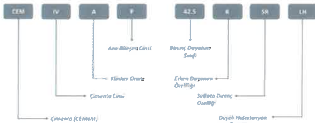
Şekil 2 : TS EN 197-1 Standardı Çimento Cinsi Kodlaması
